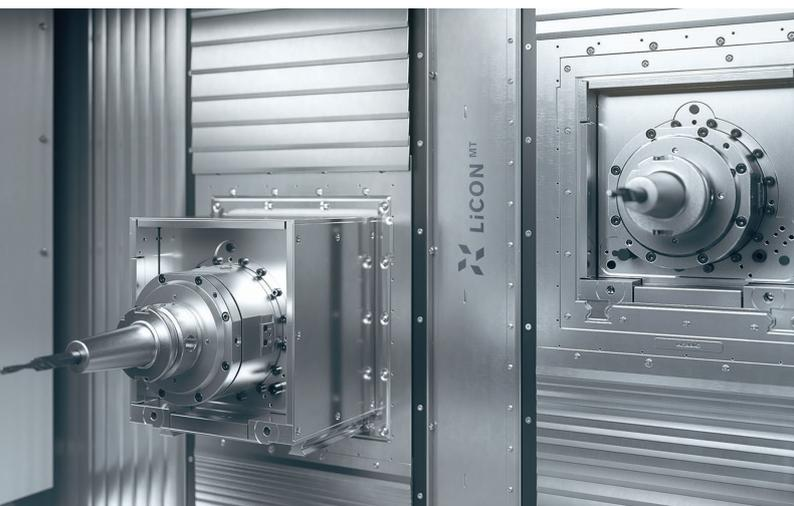
1 Mit der  $i^3$ -Technologie lassen sich beim Doppelspindler von Licon beide Spindeln unabhängig und ohne Reduzierung der Spindelsteifigkeiten in allen drei Achsen korrigieren © Licon mt
